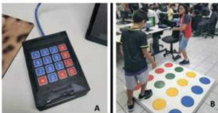
Figura 2. Elementos físicos de interação com os jogos. A) Teclado matricial para digitar valores no jogo; B) Protótipo de mesa interativa semelhante a um jogo popular chamado twister
